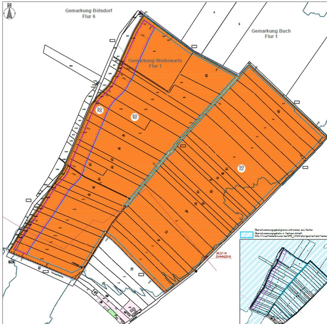
**Abbildung 2: Geltungsbereich „Solarpark Weißewarte“ des vorhabenbezogenen Bebauungsplanes (graue Linie) mit den Sondergebieten Photovoltaik (orange Flächen) und den Baufeldern (blaue Linie)** (adaptierter Ausschnitt nach: IIP – INGENIEURBÜRO INVEST-PROJEKT GmbH Westeregeln, April 2024, Vorzeitiger vorhabenbezogener Bebauungsplan „Solarpark Weißewarte“ der Stadt Tangerhütte – Teil I – Planzeichnung)
