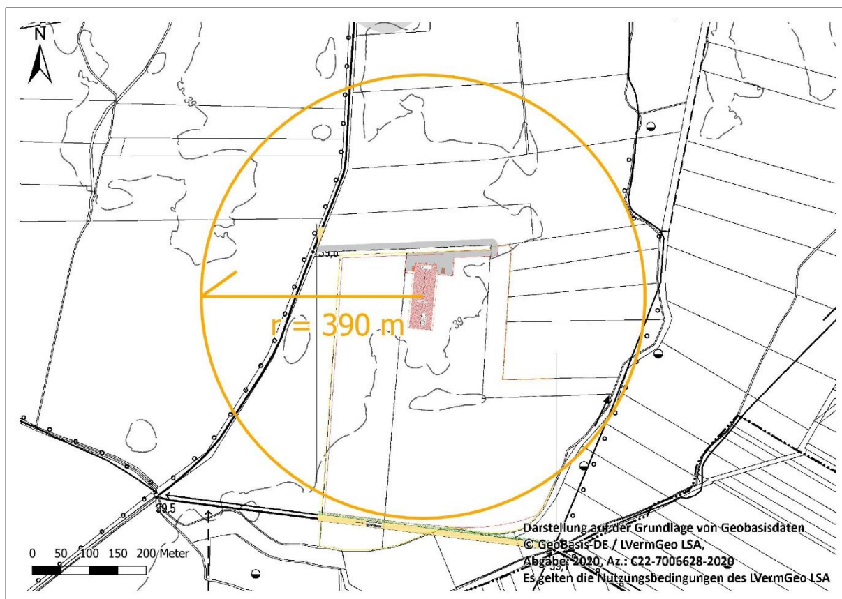
Abb. 6: Mindestabstand des Vorhabens zu empfindlichen Ökosystemen gemäß Anhang 1 der TA Luft 2002.
